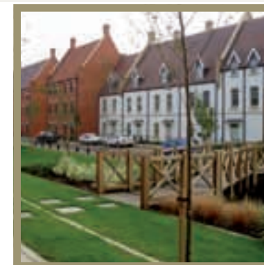
Upton in Engeland is doorsneden door wadi's. Dat zijn greppels met vegetatie die overvloedig regenwater kunnen opvangen. In droge periodes kunnen ze als speelterrein dienen. © Tcpa
